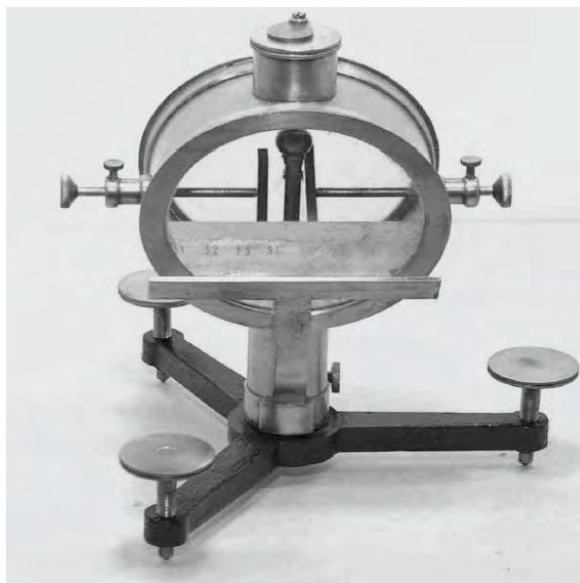
Fig. 3. – Un elettroscopio di Elster e Geitel degli inizi del ventesimo secolo. Questo strumento è composto da un elettroscopio attraverso il quale può essere pompato un flusso d'aria. Per gentilezza del Gabinetto di Fisica dell'Istituto Calasanzio di Empoli.
